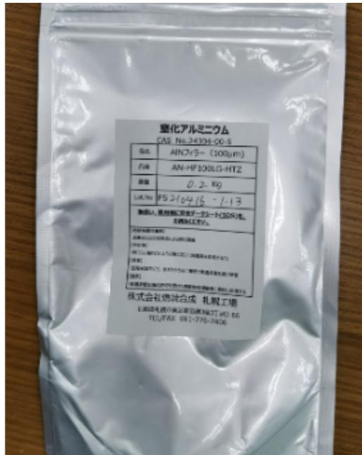
高性能氮化铝陶瓷取决于氮化铝粉体的质量，到目前为止，制备氮化铝粉体有氧化铝粉碳热还原法、铝粉直接氮化法、化学气相沉积法、自蔓延高温合成法等多种方法，各种方法都有其自身的优缺点。综合来看，氧化铝粉碳热还原法和铝粉直接氮化法比较成熟，是目前制备高性能氮化铝粉的主流技术，已经用于工业化大规模生产。氮化铝粉体制备的技术发展趋势主要表现在两个方面：一是进一步提升氮化铝粉体的性能，使之能够制造出更高热导率的氮化铝陶瓷产品；二是进一步提升氮化铝粉体批次生产稳定性，增大批生产量，降低生产成本。我国目前的高性能氮化铝粉基本依赖进口，不但价格高昂，而且随时存在原材料断供的风险。因此，实现高性能氮化铝粉制造技术的国产化，已成为当务之急。
